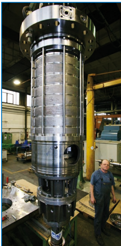
■ Монтаж вставного узла для горизонтального процессного бочечного насоса.
